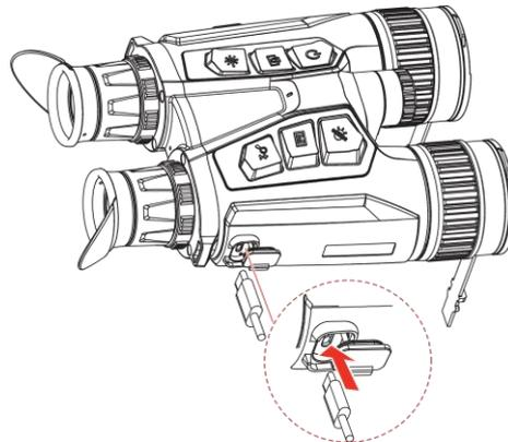
Abbildung 2-5 Gerät laden
