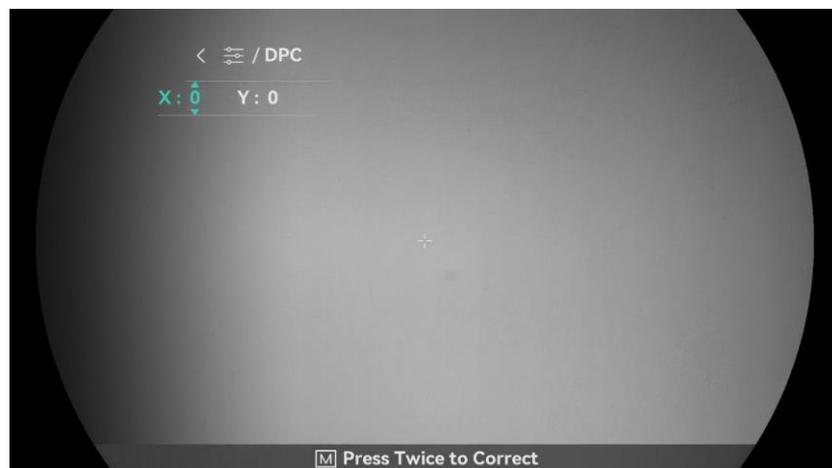
Abbildung 3-6 Defekte Pixel korrigieren
