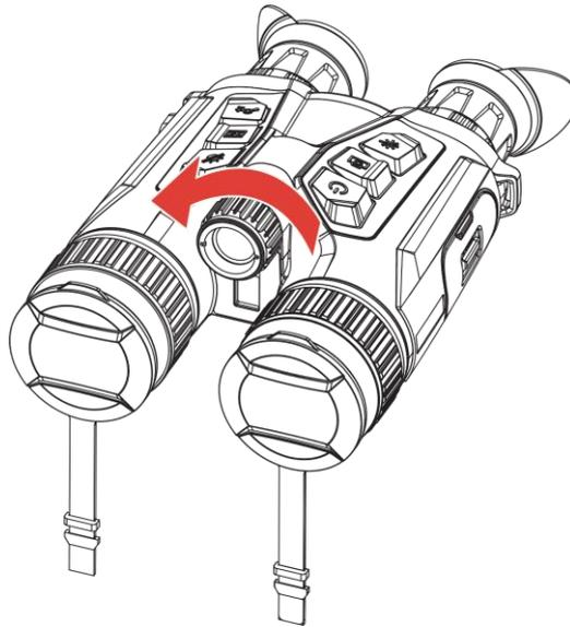
Abbildung 2-7 Drehen Sie den IR-Strahler
