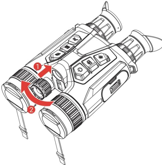
Abbildung 2-8 Montieren Sie den Strahler
